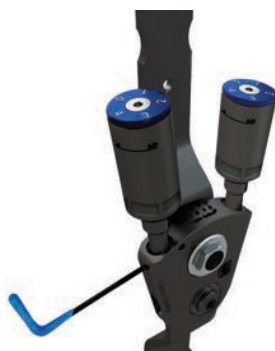
Figur 1. Lås op / lås ROM-justeringen ved hjælp af 1,5 mm unbrakonøglen til at løsne / stramme ROM-låseskruen.
