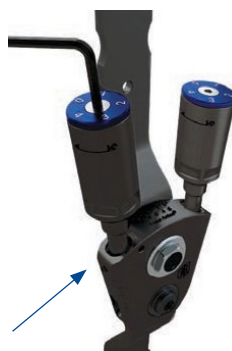
Figur 3. Løsn ROM-drejeskruen med 2 mm justeringsnøglen, og nulstil ROM-indstillingen ved at dreje den blå ROM-drejeknap. ROM-låsens indstillingsskruer fungerer som reference for denne justering (figur 3a og 3b).
